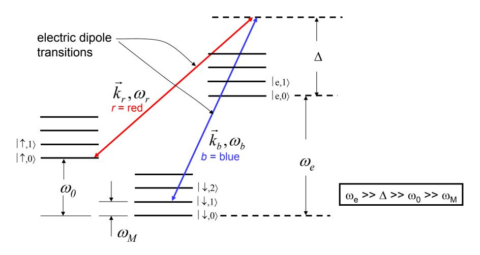
In Be<sup>+</sup>,  $\omega_e/2\pi \simeq 10^{15}$  Hz,  $\Delta/2\pi \simeq 10^{11}$  Hz,  $\omega_0/2\pi \simeq 10^9$  Hz,  $\omega_M/2\pi \simeq 10^7$  Hz
